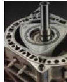
Abb. 2: Läufer im Trochoidengehäuse
